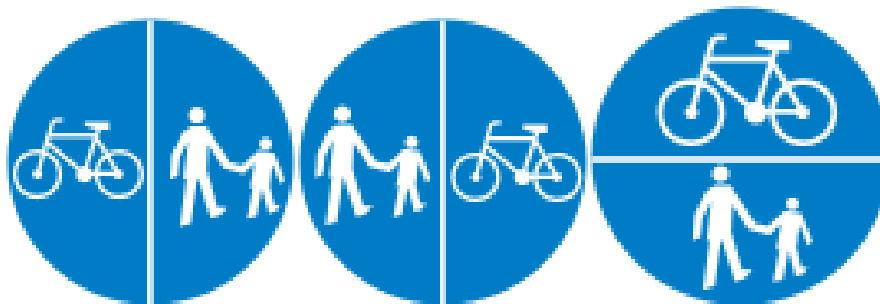
Rysunek 24 Kompilacje znaków pionowych C-13 „droga dla rowerów” i C-16 „droga dla pieszych”
